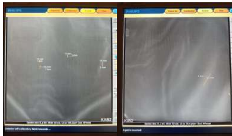
Pengujian lead apron B kuadran III dan IV
