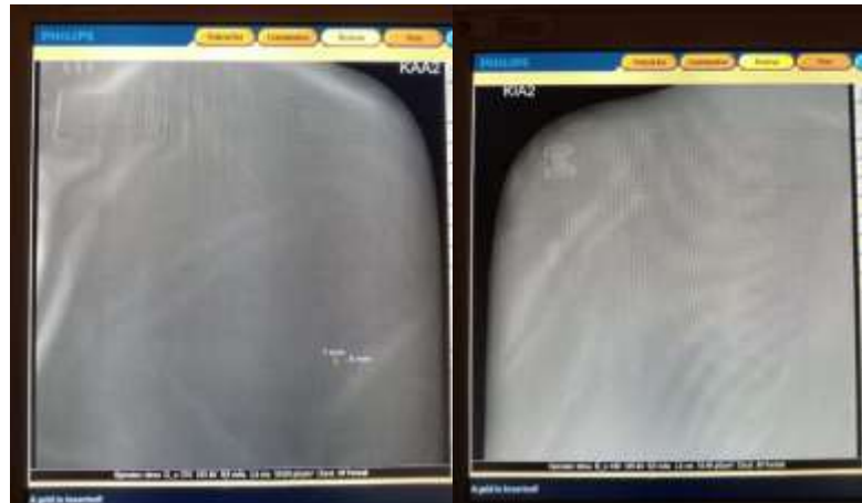
Pengujian lead apron B kuadran I dan II
