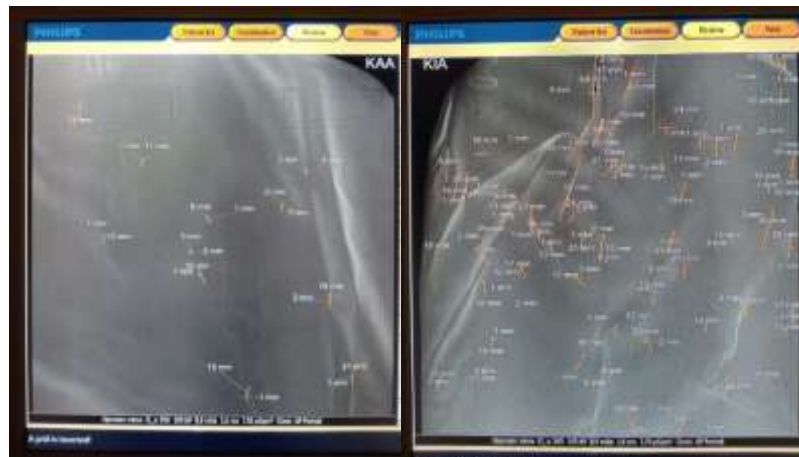
Pengujian lead apron A kuadran I dan II
