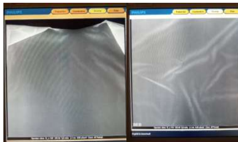
Pengujian lead apron A kuadran V dan VI
