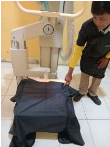
Pengukuran lead apron B Kuadran 5 bagian belakang atas
