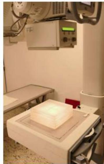
Gambar 2. 7 uji *image uniformity* menggunakan PMMA (IAEA, 2023)
