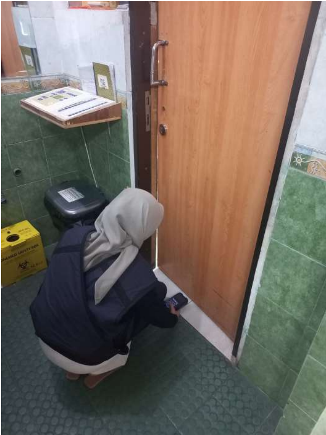
Lampiran 6 : Dokumentasi Pengujian Laju Paparan Radiasi Pada Pintu Masuk Ruang Serbaguna dan Ruang Pesawat Sinar-X di Instalasi Radiologi Rumah Sakit Pekanbaru Medical Center
