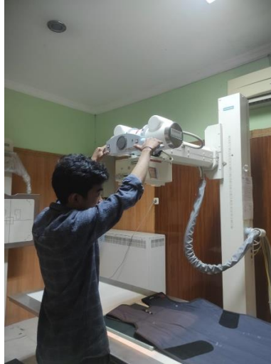
Gambar 4.4 Pengujian lead apron di Unit Radiologi Rumah Sakit Pekanbaru Medical Center
