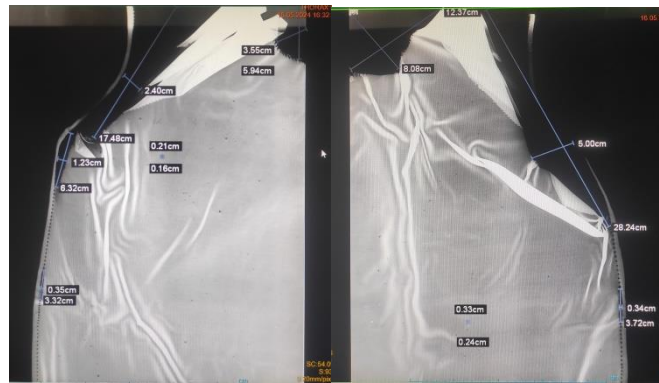
Hasil Pengujian Lead Apron 1 Kuadran I dan II
