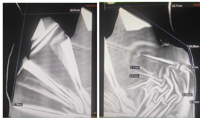
Hasil Pengujian Lead Apron 2 Kuadran I dan II
