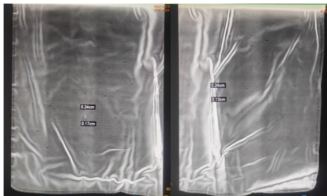
Hasil Pengujian Lead Apron 5 Kuadran III dan IV
