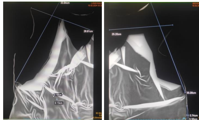
Hasil Pengujian Lead Apron 5 Kuadran I dan II
