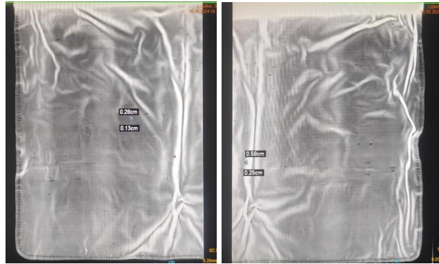
Hasil Pengujian Lead Apron 4 Kuadran III dan IV
