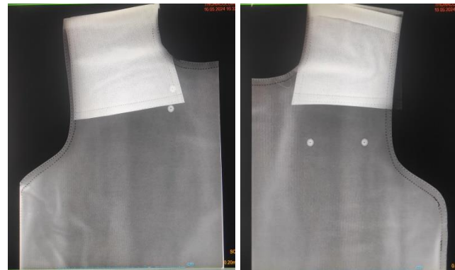
Hasil Pengujian Lead Apron 3 Kuadran I dan II
