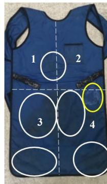
Gambar 4. 11 Kondisi Fisik dari lead apron 3 Di Instalasi Radiologi Rumah Sakit Prima Pekanbaru,
