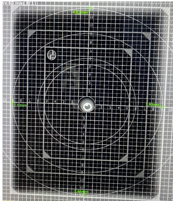
Gambar 4.2 Hasil gambaran radiograf pengujian kedua dari focal spot kecil
