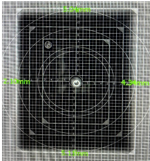
Gambar 4.1 Hasil gambaran radiograf pengujian pertama dari focal spot kecil
