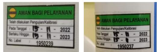
Terdapat rekaman kalibrasi alat ukur radiasi yang ditandai dengan stiker label kalibrasi pada masing-masing alat modalitas radiologi.
