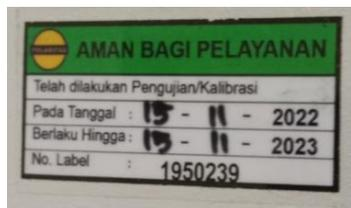
Gambar 4.13 Stiker kalibrasi pesawat X-ray konvensional
