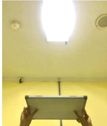
Gambar 4.8 Meletakkan Kaset di Bawah Lampu
