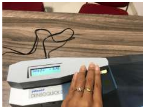
Gambar 4.5. Melakukan Pengujian dengan Densitometer
