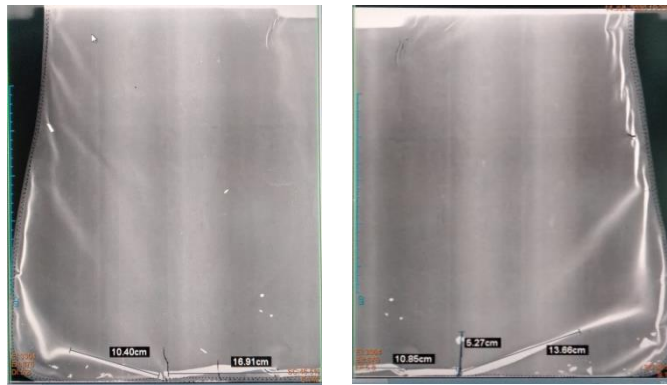
Hasil pengujian lead apron 2 kuadran 3 dan 4
